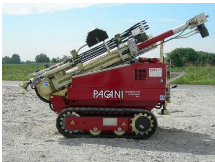
Slika 5: Dinamični penetrometer TG 63-100
